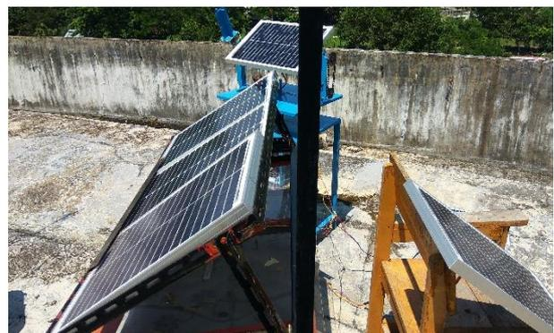
**Gambar 4.** Pengujian DAST dengan Panel SPV yang Dipasang Statis Menghadap Timur dan Barat
