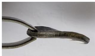
Gambar 14. Bentuk Benda Kerja Menggunakan *Tool Punch B*
