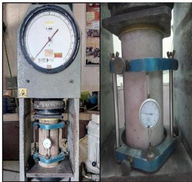
Gambar 3. Pengujian Modulus Elastisitas
