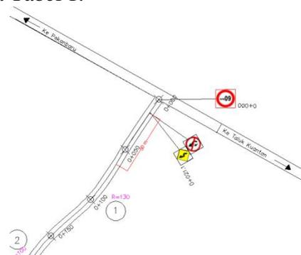
Gambar 8 Penempatan Rambu dan Marka dari awal ke akhir Pada STA 0+000 s/d 0+250
