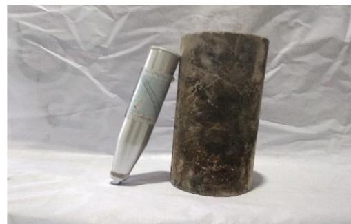
Gambar 2. Pengujian *Hammer* Pada Beton
