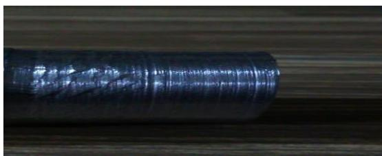
**Gambar 25** Hasil Pembubutan Pengujian 6 Data *Chatter*
