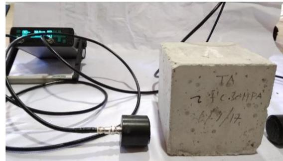
Gambar 2. Pengujian UPV Pada Beton
