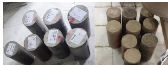
Gambar 2. Beton Sebelum dan Sesudah direndam pada Air Campuran Sulfat
