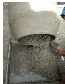
Gambar 4. Proses Pembuatan Benda Uji
