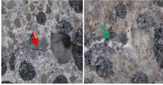
Gambar 2. Keretakan pada Beton Sebelum dan Sesudah Perbaikan oleh Bakteri
