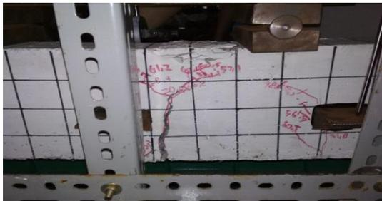
Gambar 3. Pola Retak Tampak Depan
