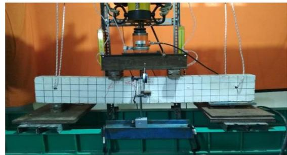
Gambar 2. Proses Pengujian Kuat Lentur
