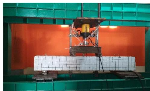
Gambar 1. Benda Uji di *Loading Frame*
