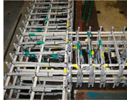
Gambar 1. Pengujian elemen join balok kolom menggunakan tulangan FRP (Mady, 2011).
