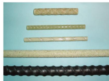
Gambar 2. Tipe Tulangan yang Sering digunakan (ACI 440.1R-15).
