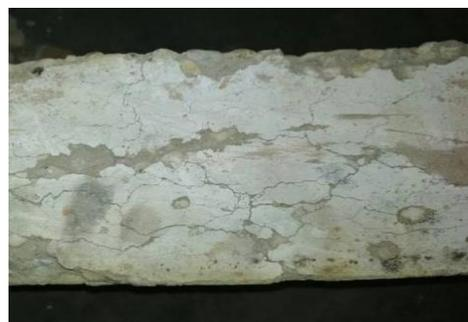
Gambar 5 Retak Pada Balok BB60
