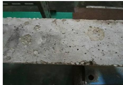
Gambar 4 Retak Pada Balok BB30
