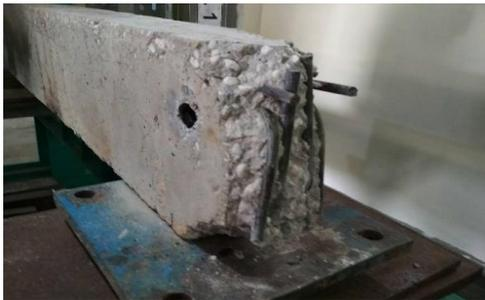
Gambar 6 Pengelupasan Pada Balok BB30
