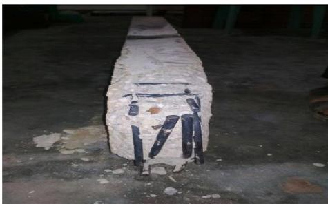
Gambar 7 Pengelupasan Pada Balok BB60
