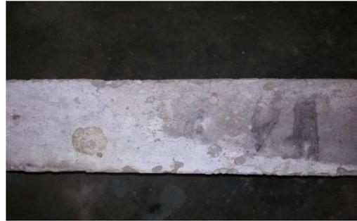
Gambar 8 Perubahan Warna Pada Balok BB30
