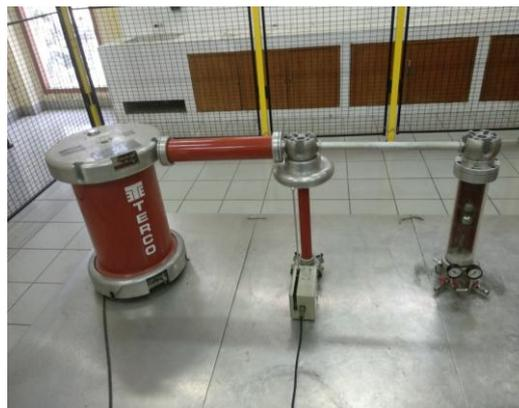
Gambar 1 Bentuk Fisik Rangkaian Tegangan Tembus Isolasi Gas Argon
