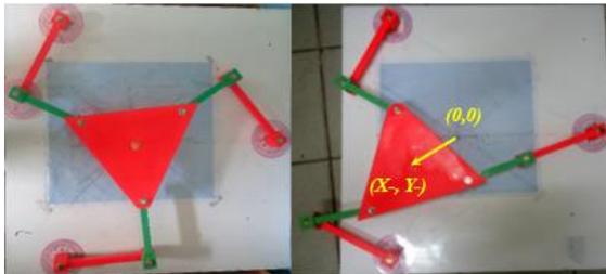
**Gambar 16.** Pengukuran Area Kerja Searah Sumbu A-
