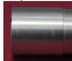
Gambar 11. Hasil Permukaan dari Proses Pembubutan Konvensional
