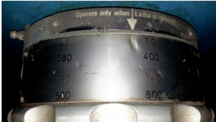
Gambar 7. Tabel Putaran Mesin pada Mesin Bubut
