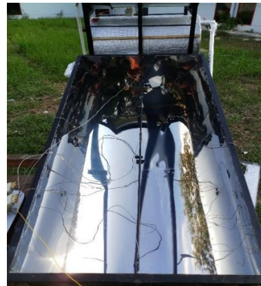
Gambar 4. Alat Pemanas Air Energi Surya Menggunakan Kolektor Parabolik.
