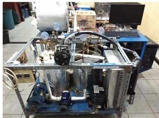
Gambar 4 Pembangkit Listrik Sistem ORC
