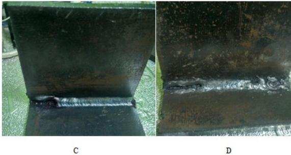
Gambar 6. Spesimen Sebelum Pengujian Liquid Penetran
