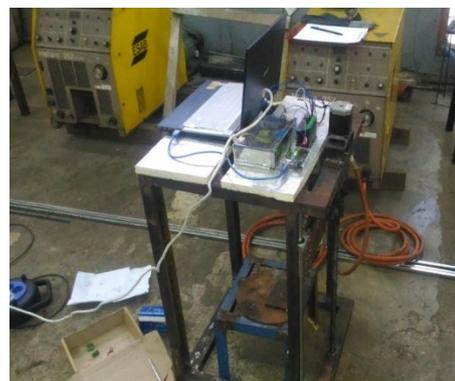
Gambar 2 Mesin Las SMAW Sliding Adaptive Vertikal
