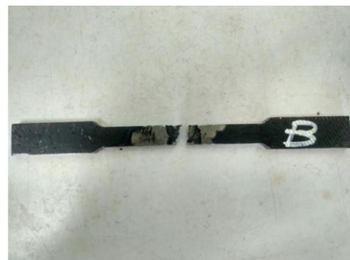
Gambar 8. Spesimen Hasil Uji Tarik
