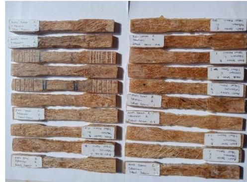
**Gambar 6. Spesimen Uji Tarik**
