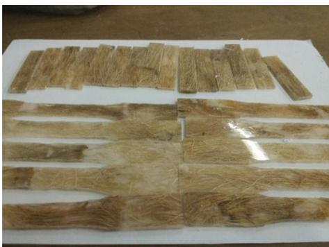
**Gambar 5. Bentuk Spesimen Uji**
