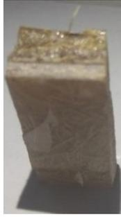
**Gambar 15.** Patahan spesimen uji impact *charpy*.
