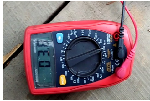
Gambar 6. Pengukuran voltase pada generator listrik
