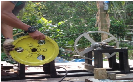
Gambar 4. Pemasangan flywheel pada poros transmisi
