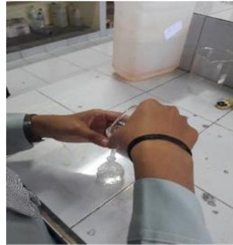
Gambar 2. Air dituang pada *picnometer*
