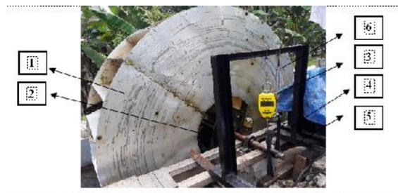
Gambar 1. Mekanisme pengujian kincir air
