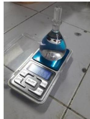
Gambar 3. Air ditimbang dengan neraca analitik
