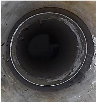
Gambar 3 Permukaan Pipa Kondisi Korosi 2
