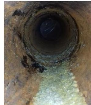
Gambar 2 Permukaan Pipa Kondisi Korosi 1
