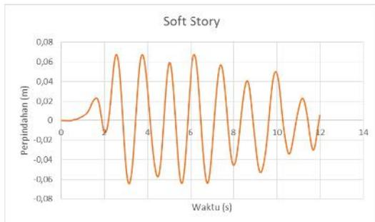
Gambar 6. Nilai Perpindahan pada Joint 530 Struktur *Soft Story*
