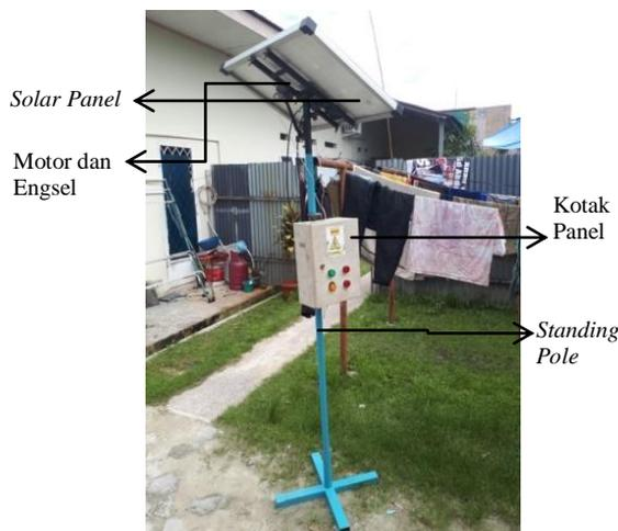
Gambar 3. Instalasi Solar Sel Secara Keseluruhan
