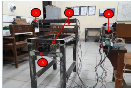
Gambar 15 Alat Pemotong Pelat dan Sistem Kontrol
