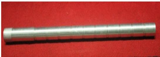
Gambar 3 Spesimen Alumunium 6061.
