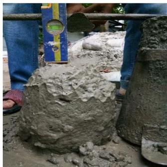
Gambar 1. Pengukuran *Slump*
