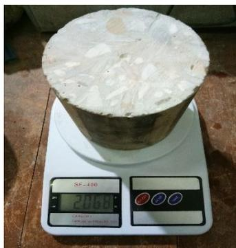
Gambar 2. Pengujian Porositas
