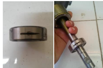
Gambar 2. Kerusakan Buatan pada Bearing
