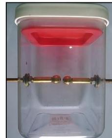
**Gambar 9.** Perancangan elektroda bola-bola dan wadah uji.
