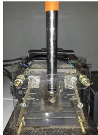
**Gambar 10.** *Cam-switch* saat dioperasikan Secara Manual
