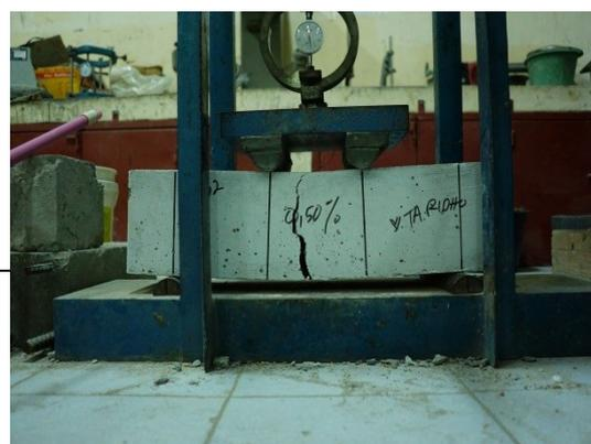
Gambar 13. Beton serat kawat bendrat variasi 0.50% setelah uji lentur
