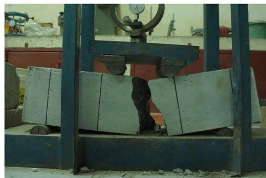
Gambar 12. Beton normal setelah uji lentur
