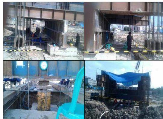
Gambar 2 Pengujian beban statis (SLT)
