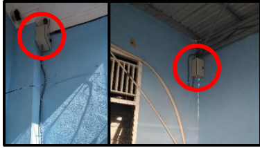
Gambar 7. Posisi Sensor Akselerometer pada Tingkat 2 dan 3
