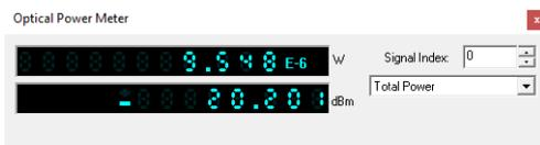
Gambar 9 Pengukuran OPM pada daya 1,5 dBm untuk *upstream*
