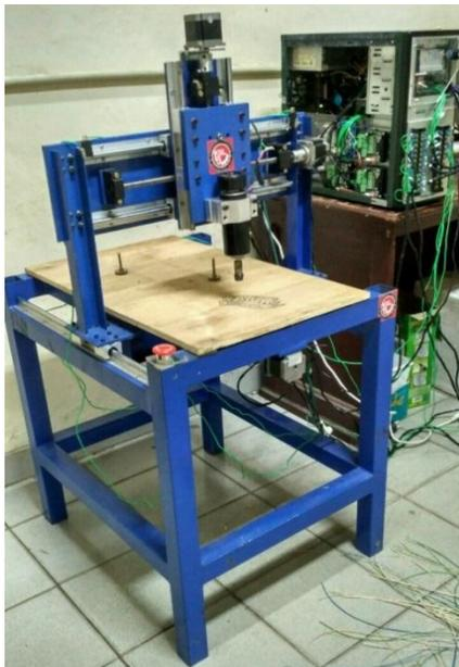
**Gambar 13.** Hasil Pembuatan dan Perakitan Mesin CNC Router 3-axis
