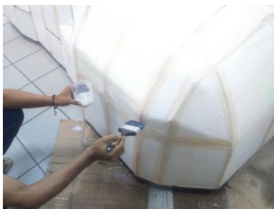
Gambar 11 Proses Pelapisan Polyfoam Coat .
