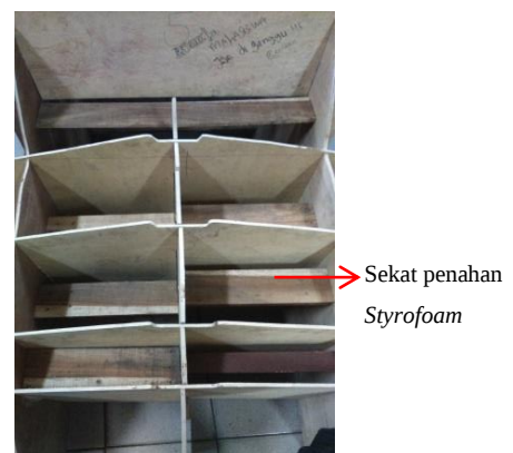
Gambar 8 Sekat penahan Styrofoam.
