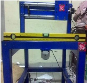
**Gambar 10** Kerataan meja kerja di ukur menggunakan *waterpass*
