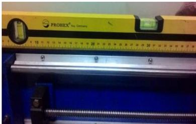
**Gambar 11** Kelurusan plat Y diukur dengan menggunakan *waterpass*
