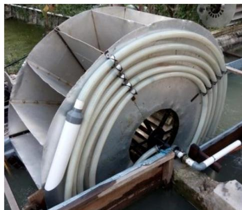
Gambar 1. Pompa Spiral dengan Kincir Air
