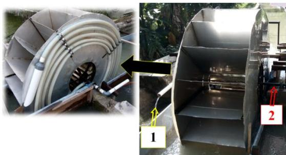
Gambar 3. Skematik Pengujian Pompa Spiral dengan Kincir Air
