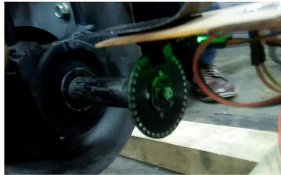
**Gambar 21.** Hasil Pengujian Sensor Saat *Screw Conveyor Stop*
