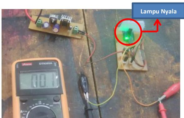
**Gambar 20.** Pengujian *Detector* Saat celah Terhalang
