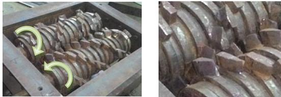
Gambar 5 Mata potong datar/tumpul susunan *helical*.
