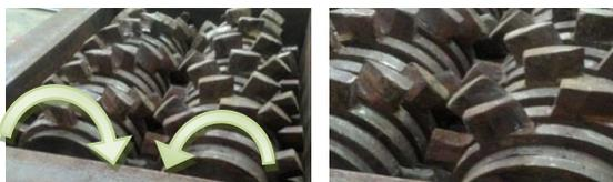
Gambar 7 Mata potong datar/tumpul susunan acak dan *helical*.
