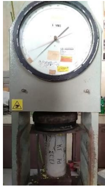
Gambar 2. Pengujian Kuat Tekan
