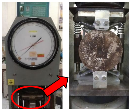
Gambar 3. Pengujian Kuat Tarik Belah
