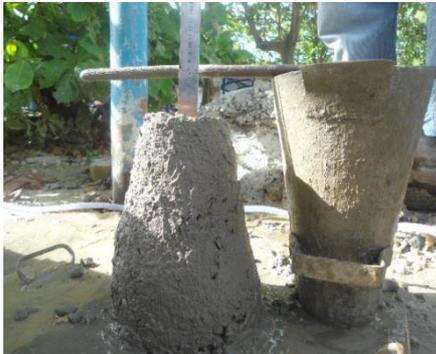
Gambar 3. Pengukuran *Slump*
