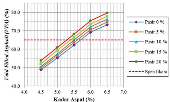
Gambar 4. Grafik Hubungan *VFA* dengan Kadar Aspal
