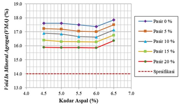
Gambar 3. Grafik Hubungan *VMA* dengan Kadar Aspal
