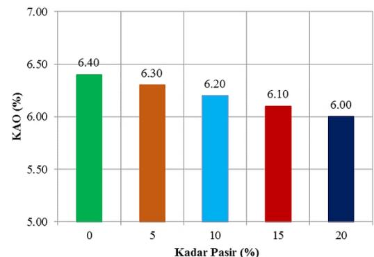
Gambar 7. Diagram Hubungan KAO terhadap Kadar Pasir Alam
