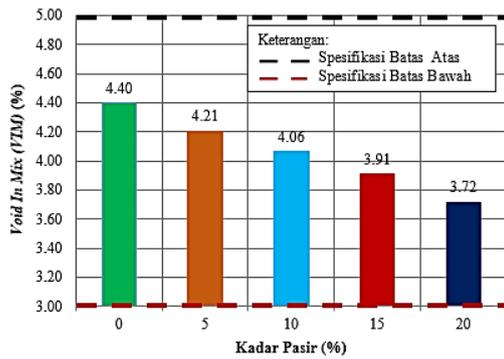
Gambar 8. Diagram hubungan *VIM* Terhadap Kadar Pasir Alam
