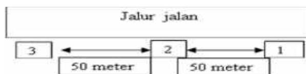
Gambar 6.1 peletakan sensor
