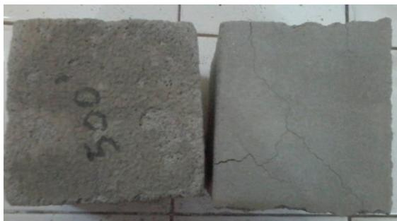
**Gambar 7. Furnace dengan suhu 500°C**
