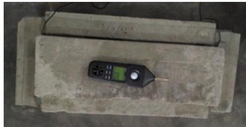
**Gambar 4. Loudspeaker didalam dan alat akustik diluar bata ringan**
