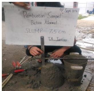
Gambar 1 Pengujian *workability*
