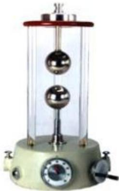
Gambar 3.3. Alat Pengujian Tegangan Tembus Isolasi Udara
