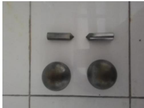
Gambar 3.4. Elektroda Bola-Bola dan Elektroda Jarum-Jarum
