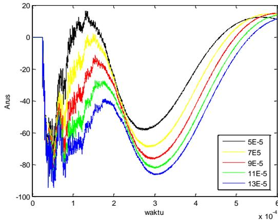
Gambar 4.10 Gelombang Arus yang Melewati Arrester pada Fasa C terhadap Pengaruh Perubahan tau
