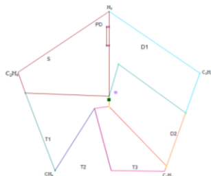
Gambar 19 Hasil Uji DGA Garuda Sakti Tahun 2012 Menggunakan Metode Duval Pentagon
