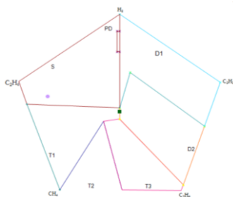
Gambar 12 Hasil Uji DGA Dumai Tahun 2015 Menggunakan Metode Duval Pentagon
